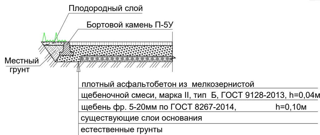
КОНСТРУКЦИЯ ПОКРЫТИЯ ТРОТУАРОВ И ОТМОСТОК
